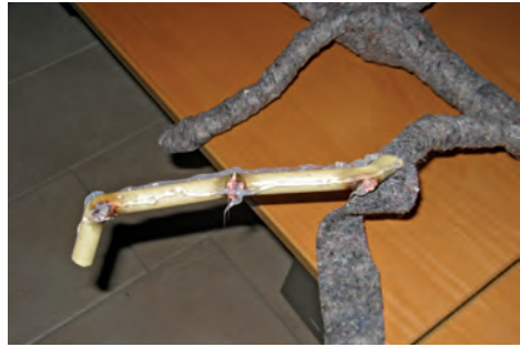
Afbeelding 14. Plak met aquariumkit stroken synthetisch materiaal rond de PVC buizen. / Picture 14. Glue strips of synthetic cloth around the PVC tubes with silicone.
