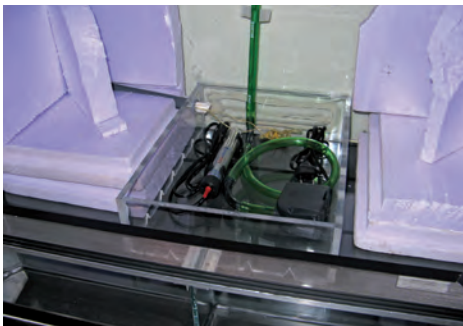
Afbeelding 5. Pompruimte met de aquariumverwarmer en de circulatiepomp. / Picture 5. Pump compartment with the aquarium heater and the circulation pump.
