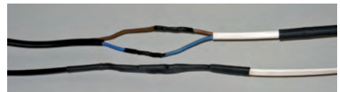
Afbeelding 8. Het verbinden van de elektriciteitsdraden met krimpkousjes. / Picture 8. Connecting the electrical wires with heat shrink.
